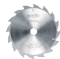
Hoja de sierra HM 160 x 1,2/1,8 x 20 mm, Z 16, WZ, para cortes longitudinales de madera
